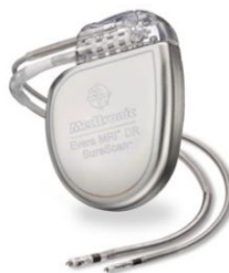
Figura 3. MP composto por gerador e eletrodos 2 .
